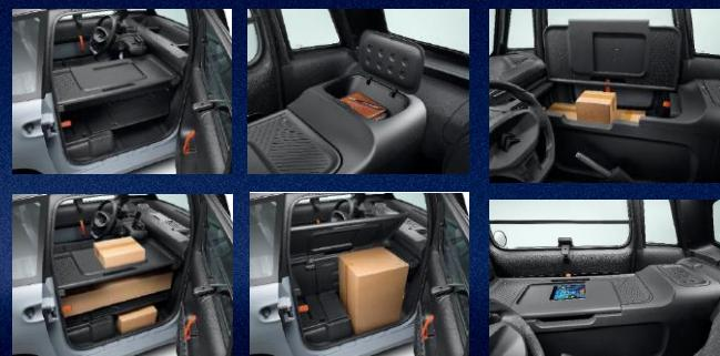
Remplacement du siège passager par une boîte modulaire et protégée. La paroi de séparation verticale vient délimiter la zone conducteur de la zone de chargement
