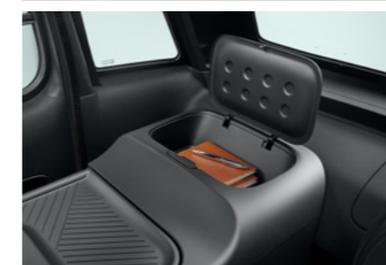
Modulable et escamotable, la tablette peut soit être relevée vers le conducteur pour une meilleure accessibilité à la zone de stockage depuis l'extérieur, soit relevée vers la porte passager afin d'atteindre facilement le contenu depuis le siège conducteur.
